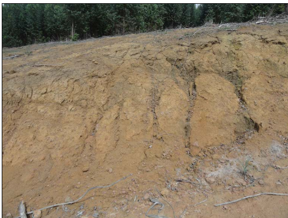
Figura 29 – Perfil de um Latossolo Amarelo observado no terreno estudado. Destaque para a coloração amarela do horizonte B
